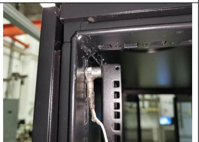
序号 4-12 加速度传感器安装位置 (顶部)
