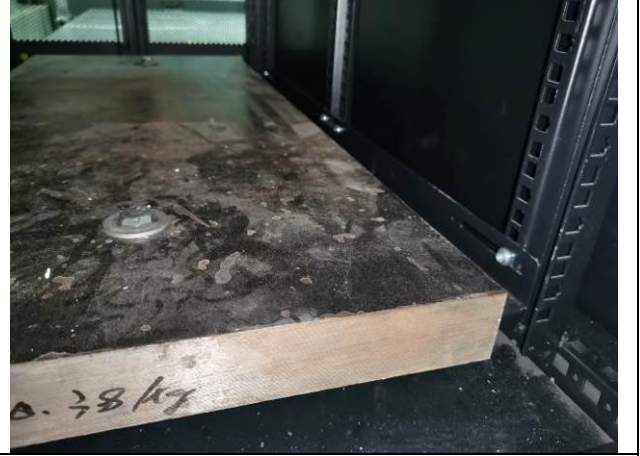
序号 4-2 模拟载荷配置位置 (第 1 层)
