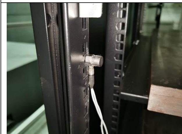
序号 4-11 加速度传感器安装位置 (中部)
