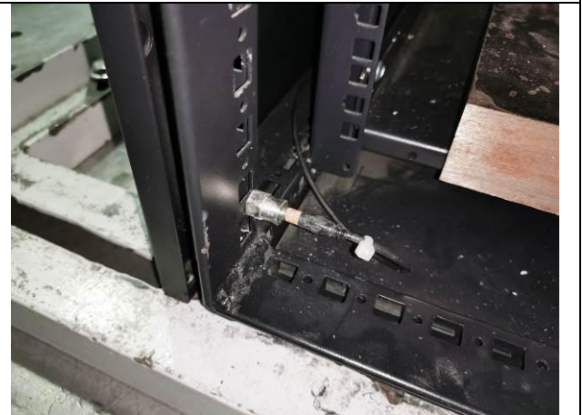
序号 4-10 加速度传感器安装位置 (底部)
